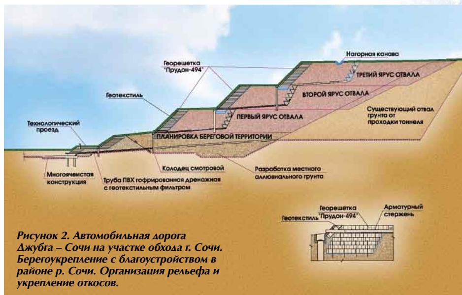
**Рисунок 2. Автомобильная дорога Джубга – Сочи на участке обхода г. Сочи. Берегоукрепление с благоустройством в районе р. Сочи. Организация рельефа и укрепление откосов.**
