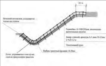
Конструкция укрепления откосов.
